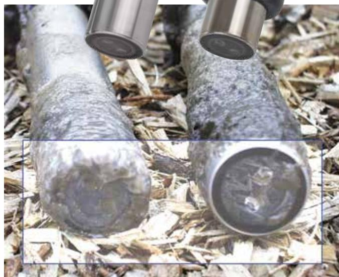
Sensor ohne bzw. mit Ultraschall-Reinigungssystem nach 30 Tagen
